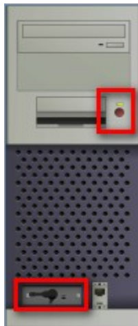
Gambar 4 : WLAN Card sudah terpasang
