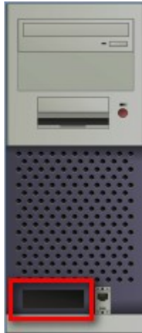
Gambar 3 : LAN Card sudah dilepas dari PC
